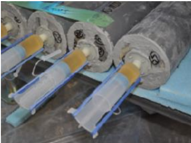
ひび割れ注入材の注入実験 ( \phi 10 \times 20 cm円柱供試体で 樹脂系注入材の注入時間を測定)
