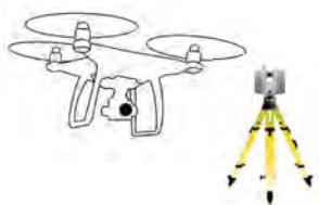
起工測量はUAVやTLSで
